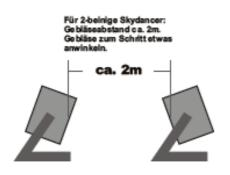
Das Gebläse wie oben beschrieben aufstellen, den Aufsatz über das Gebläse stülpen und gerade ausgerichtet am Klettverschluss fixieren. Bei unseren 2-beinigen Skydancern werden die beiden Gebläse im Abstand von ca. 2m aufgestellt und A-förmig gegeneinander leicht verschwenkt, mit Fluchtpunkt im Schritt des Dancers. Beim Einschalten des Gebläses ist der jeweilige Aufsatz festzuhalten und zu unterstützen, bis das Gebläse seine
